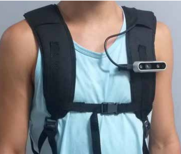
Um exemplo é o Dispositivo Vestível Biossensoriado Geolocalizável (DVB-GE0), desenvolvido pela Fama Tech. O equipamento reúne sensores fisiológicos e sistemas de geolocalização para monitoramento em tempo real.
